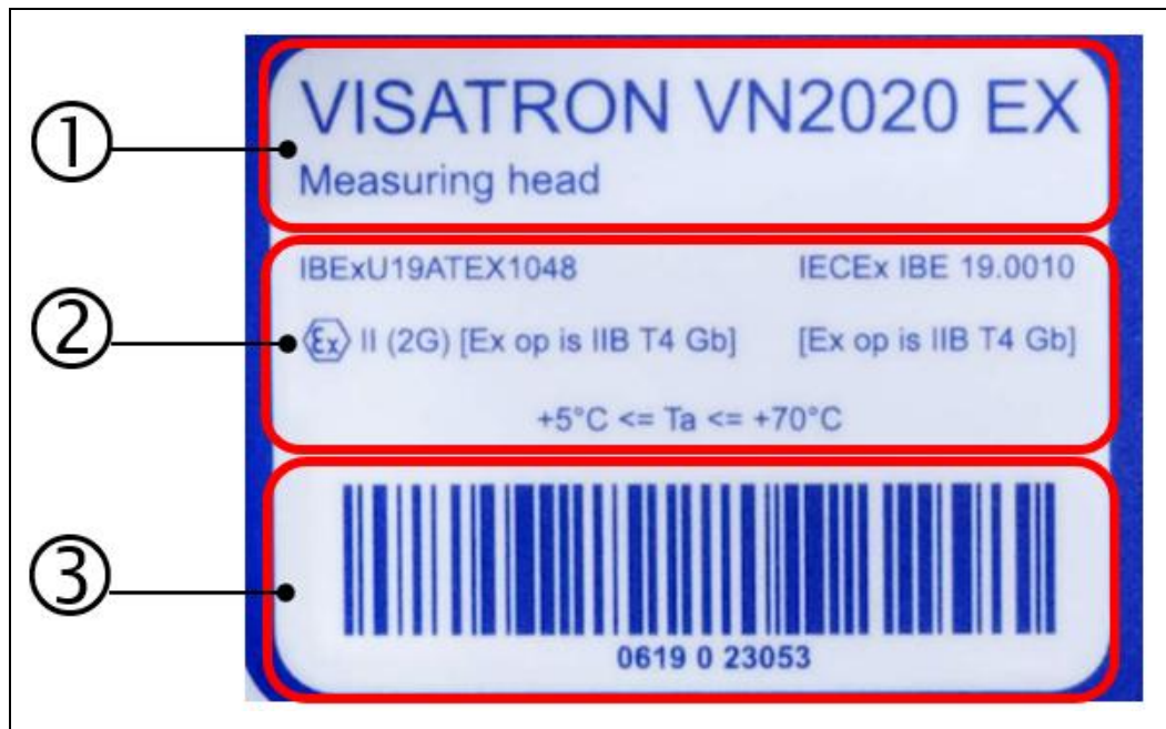
Abb.: 4 : Typenschild, Messaufsatz VISATRON ® VN2020 EX
