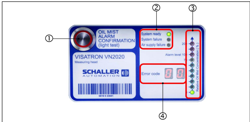
Abb.: 22 :Bedien- und Anzeigeelement, VN2020
