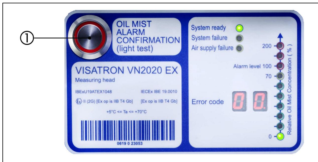
Abb.: 70 :Messaufsatz VN2020: LED- Check (Leuchtentest)
