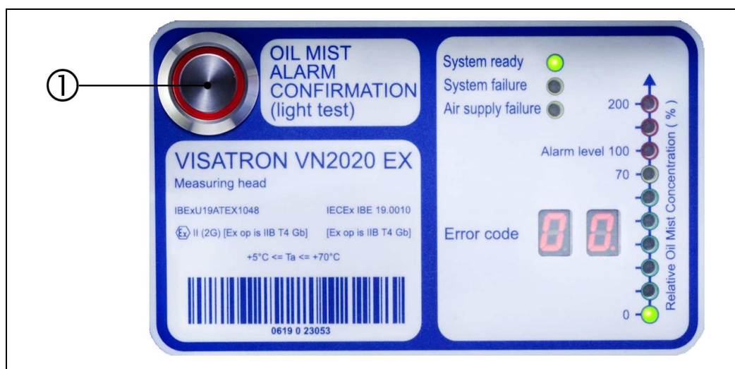
图: 70: 测量附件 VN2020 : LED 检查 (指示灯测试)
