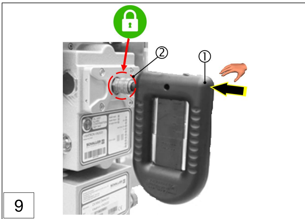
Fig. : 84 : Remplacement de la tête de mesure, VN200 (étapes 1 à 9)
