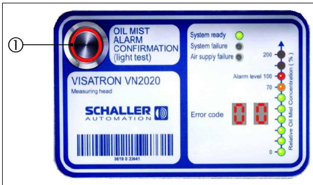
Fig. : 73 : Tête de mesure du VN200 : Confirmation de l'alarme de brouillard d'huile
