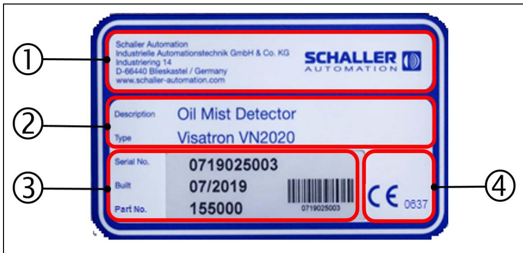
Fig. : 6 : plaque signalétique sur le boîtier de raccordement VISATRON® VN200
