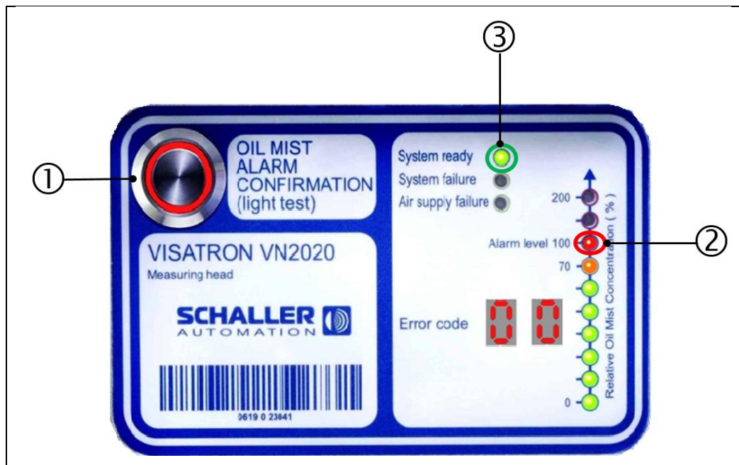
Fig.: 63 : Prueba de funcionamiento, primera puesta en servicio, VN2020/VN2020 EX
