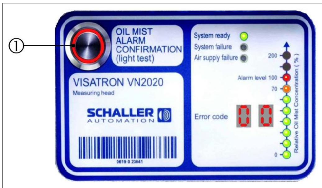
Fig.: 73 : Cabezal de medición VN2020: Confirmación de la alarma de niebla de aceite
