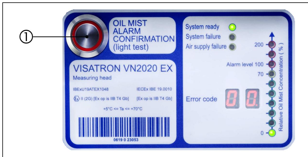
Fig.: 70 : Cabezal de medición VN2020: Prueba de led (prueba de luz)
