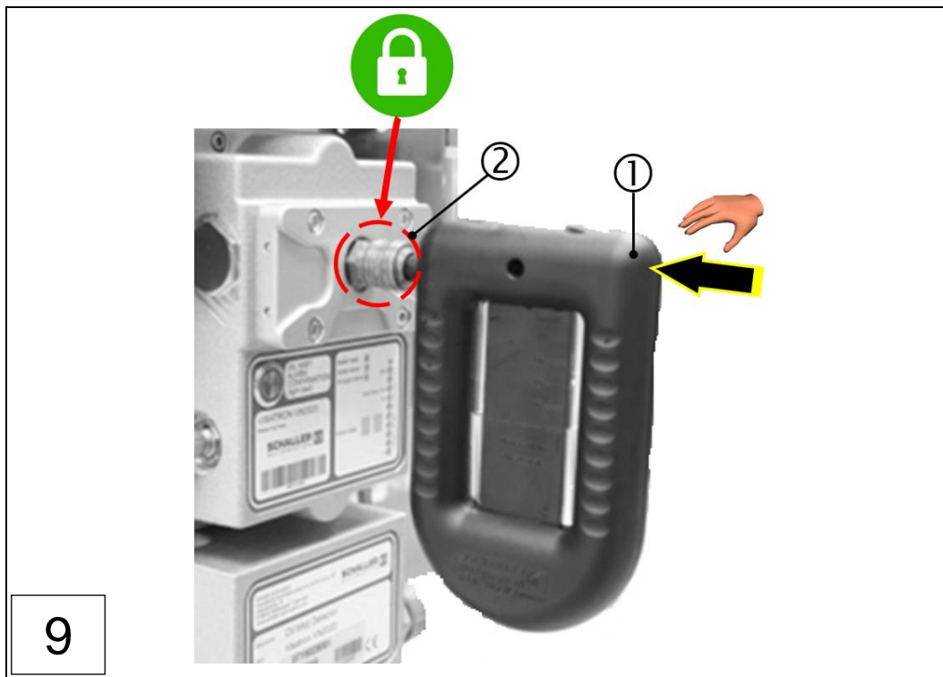
Fig.: 84 : Sustituir el cabezal de medición, VN2020 (pasos 1-9)
