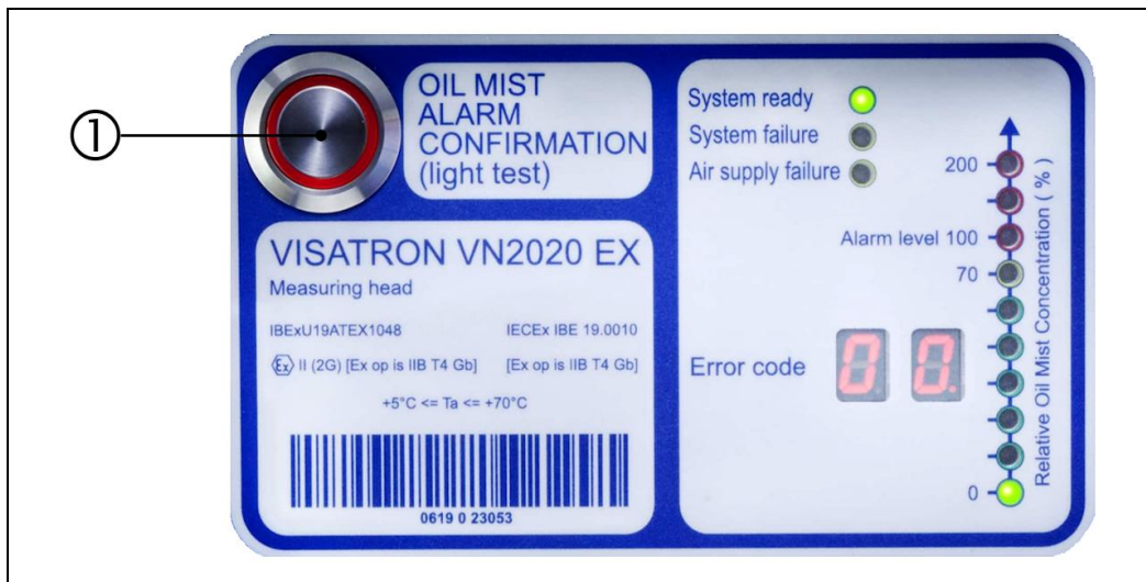
Fig.: 70 : Dispositivo di misurazione VN2020: Controllo dei LED (controllo spie)
