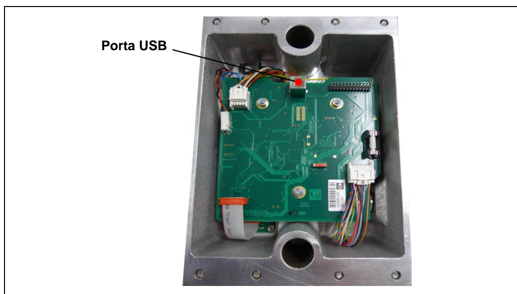
Fig.: 65 : Dispositivo di misurazione VN2020, vista retro, porta USB
