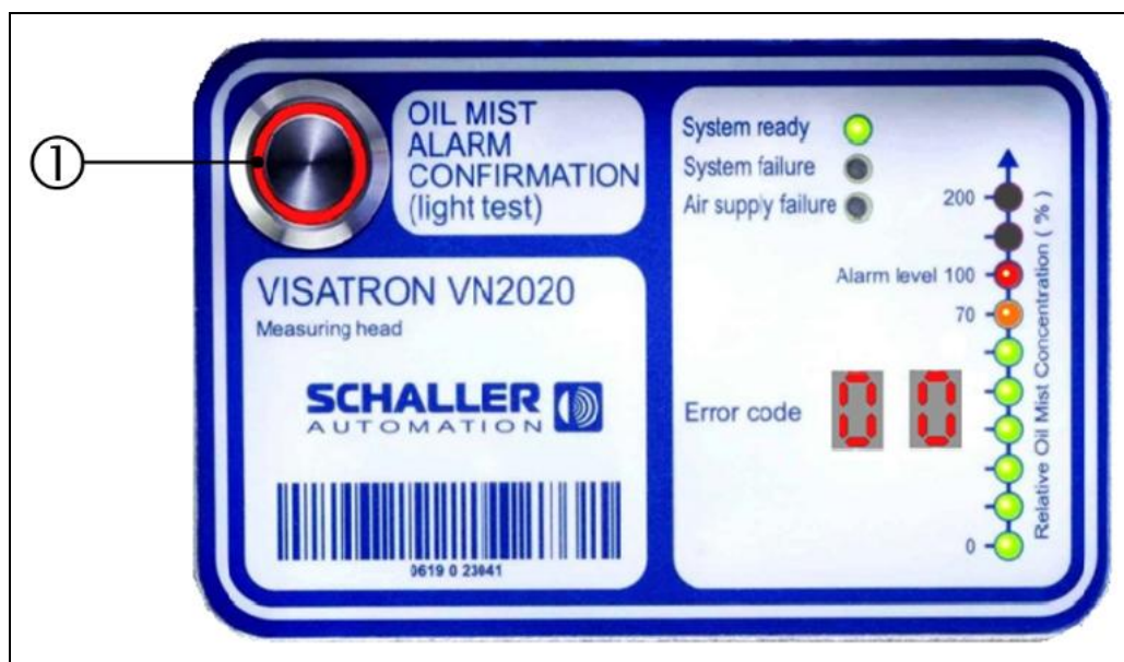
Fig.: 73 : Dispositivo di misurazione VN2020: Conferma dell'allarme di nebbie oleose
