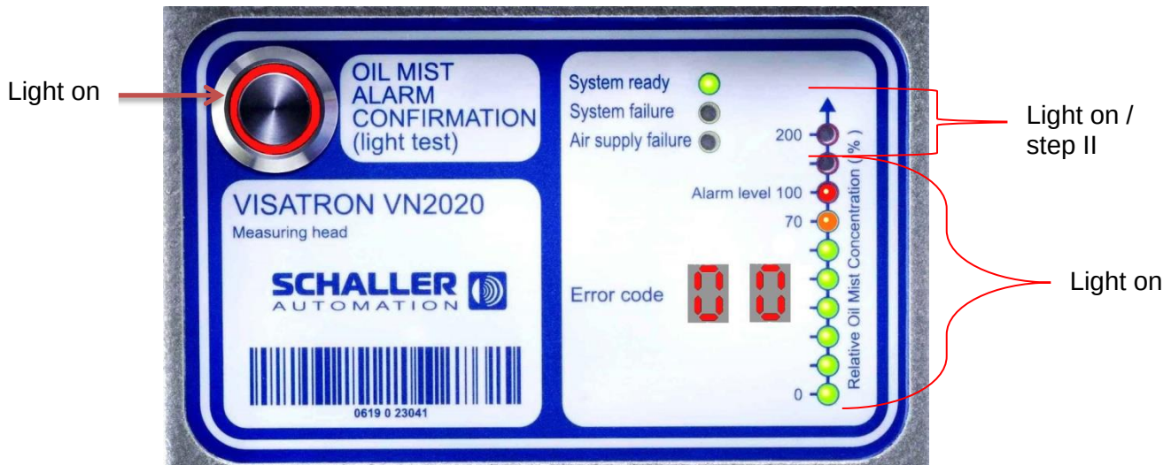
Figure 62: Beispielanzeige LED Display mit Alarm
